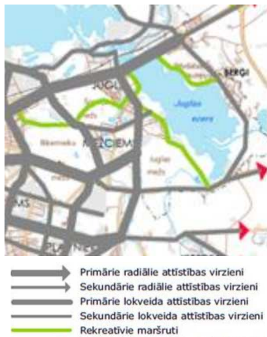
89.a attēls. Konceptuāls velosatiksmes tīkls lietišķai un rekreatīvai velobraukšanai. Avots: Rīgas pilsēta: velosatiksmes attīstības koncepcija 2015.-2030.gadam.
