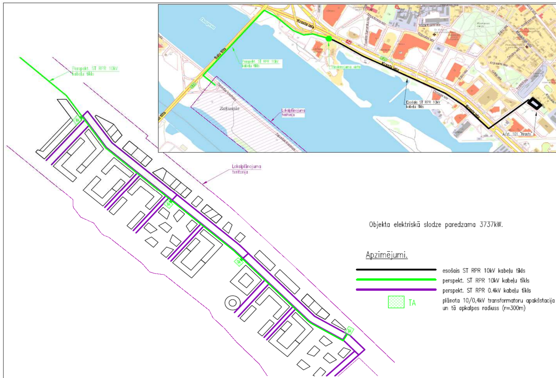
75.attēls. Elektroapgādes shēma. Avots: SIA "A.Ābeles inženieru birojs", 2017.
