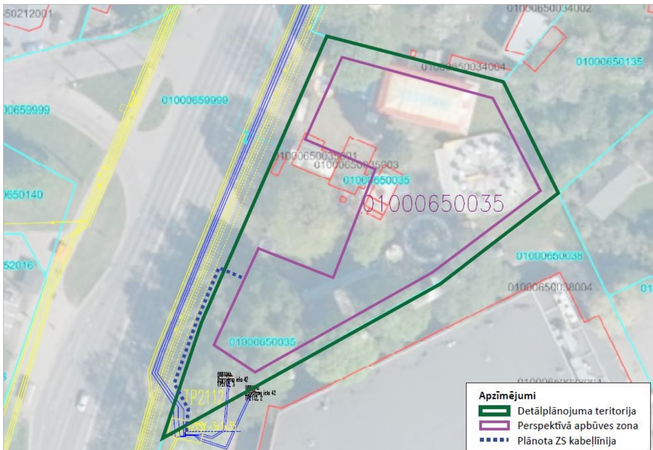
38. attēls. Plānotās elektroapgādes shēma. Avots: SIA "METRUM", 2017.
