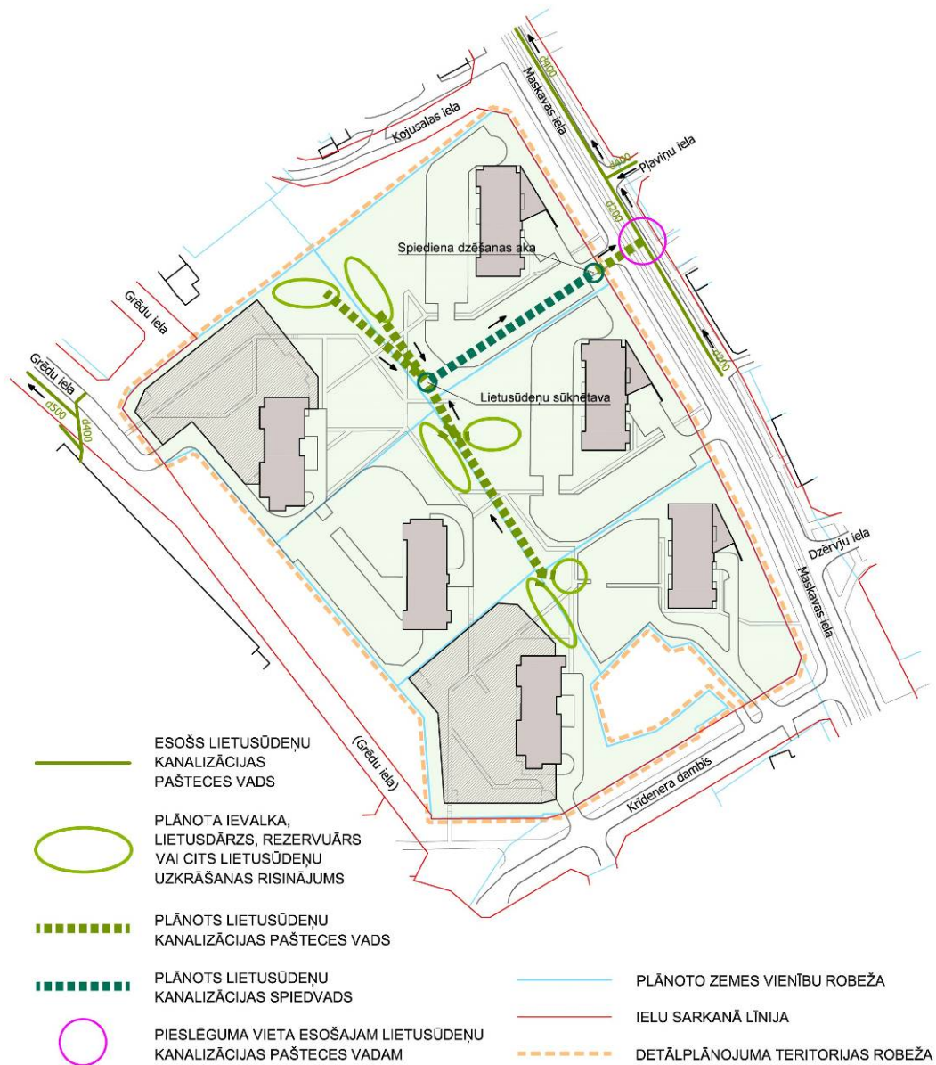
38.attēls. Lietūs kanalizācijas attīstības principiālā shēma plānotajai apbūvei
