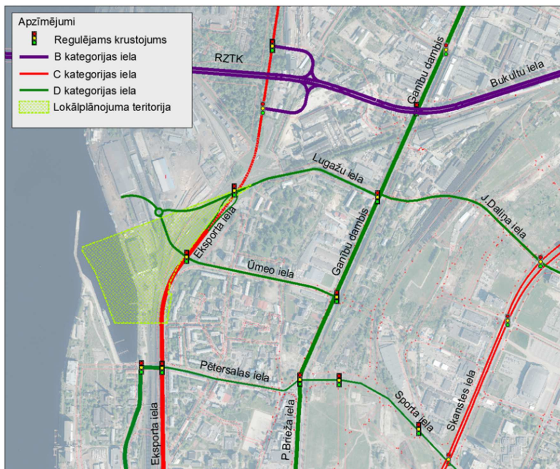
17. attēls. Perspektīvā ielu tīkla shēma un lokālpārplānojuma teritorijas sasaiste ar B, C un D kategorijas ielu tīklu
